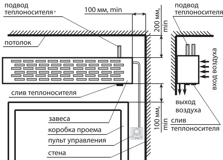
Схема монтажа ZVV-W при вертикальной установке
