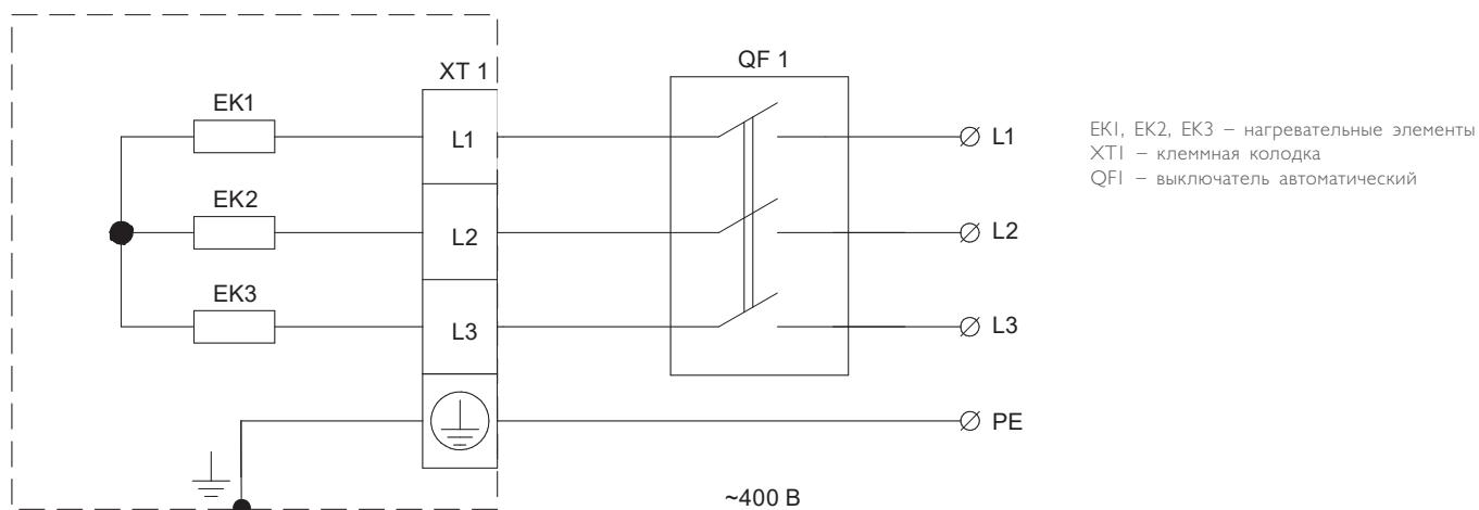
Схема подключения к электрической сети при групповом подключении IR-3.0SN2, IR-4.0SN2
