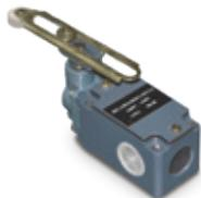
Концевой выключатель, или дверной контакт, предназначен для управления включением воздушной завесы в зависимости от открывания дверей или ворот проема, на котором установлена завеса. Это необходимо для того, чтобы оптимизировать работу завесы и производить включение только при открытии дверей. Номинальный коммутируемый ток – 10 А.
