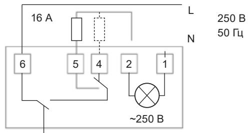
Схема электрическая IR-0.6SN3, IR-0.8SN3, IR-1.0SN3,
