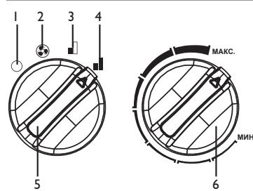
1. Положение выключения прибора
