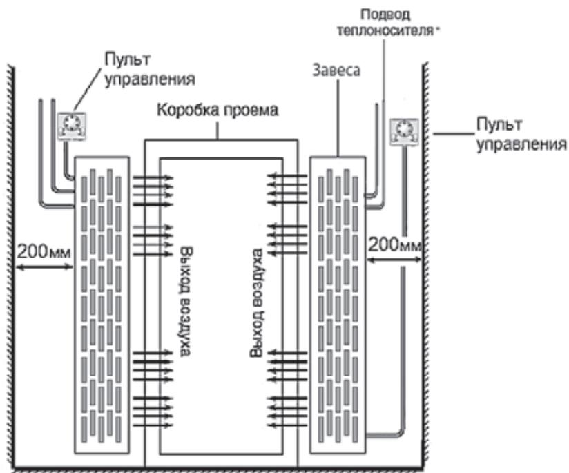
\* Сторона подключения теплоносителя в тепловых завесах серии Гольфстрим и Гольфстрим Декор может быть легко изменена в процессе монтажа с помощью разворота теплообменника. Сторона подключения электропитания фиксирована и не может быть изменена.
