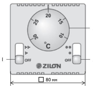
1 – переключатель включения / отключения вентилятора завесы и выбор скорости
