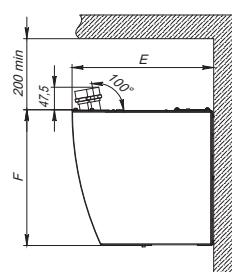
Вид сзади для ZVV-IW15, ZVV-1.5W25 и ZVV-2W40
