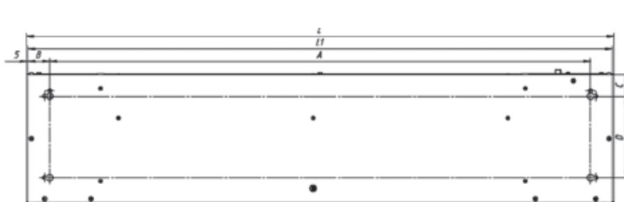
Вид сзади для ZVV-IE6T, ZVV-9T, ZVV-I.0E9T, ZVV-2EI2T, ZVV-2EI8T и ZVV-2E24T
